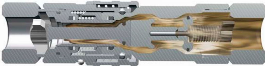
2 L'attacco femmina e maschio sono completamente collegati.
